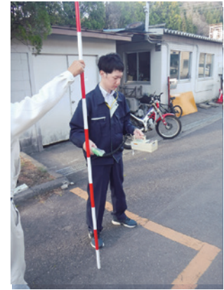
サーベイメータによる空間線量率測定の様子（生活空間等）
