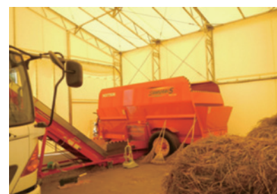
前処理施設（裁断機）の整備
