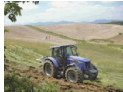
除染の様子（耕起作業）
