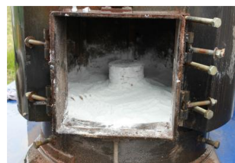
写真3 熱分解炉内底部
