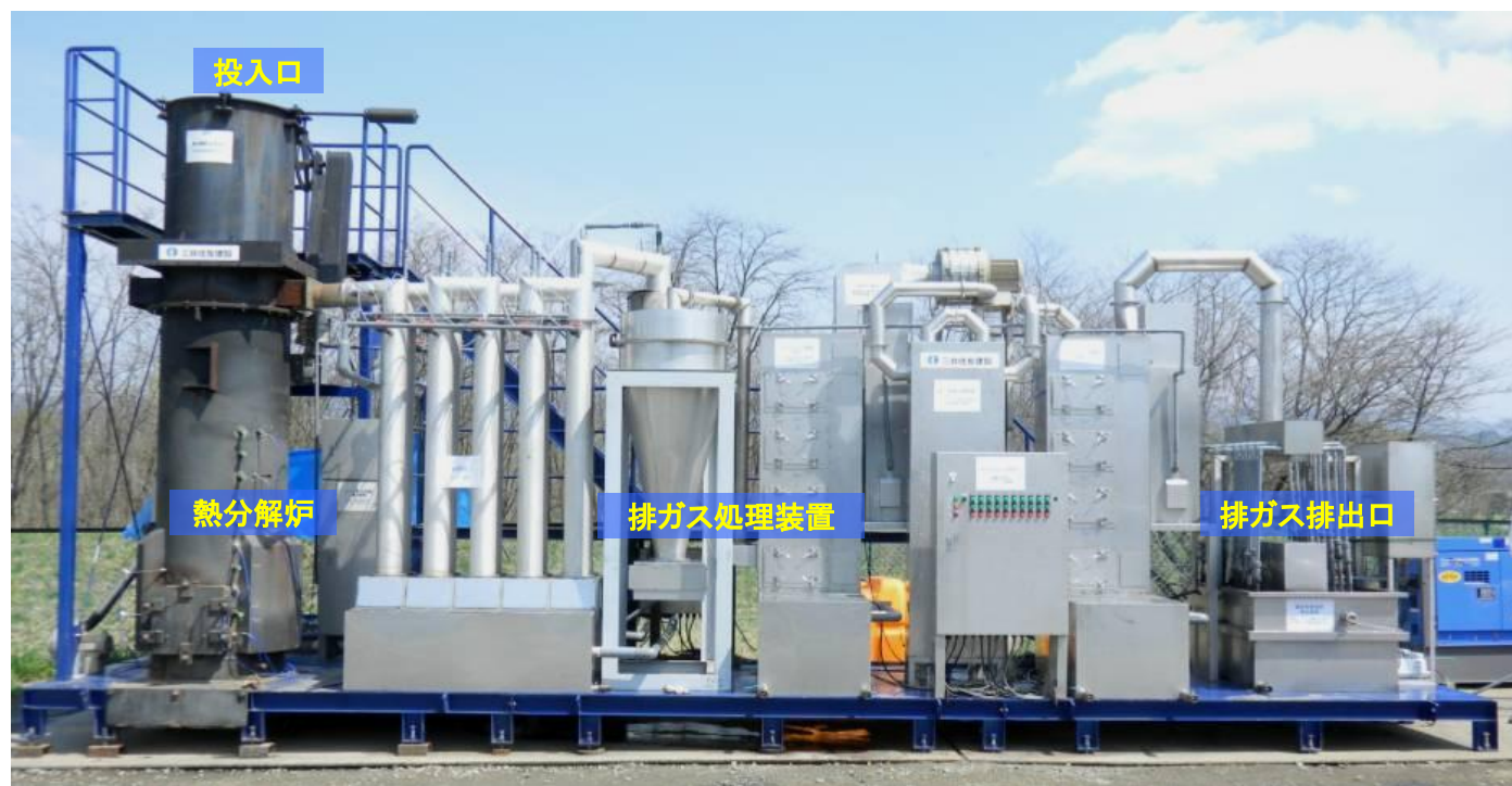
写真1 オゾンを用いた排ガス処理装置付輻射熱熱分解炉全景
