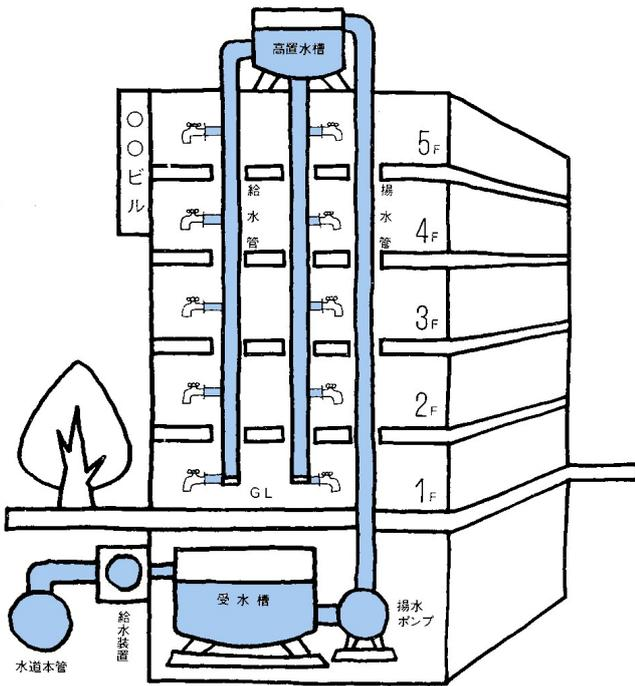
貯水槽をもつ水道のうち、貯水槽の容量が 10 m<sup>3</sup> を超えるものは、水道法で「簡易専用水道」とよばれ、①設置者が衛生的に管理すること、②定期に検査を受けること、が義務付けられています。
