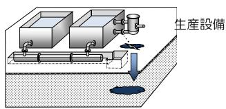
◆平成19年、金属製品製造工場で、溶液槽の配管つなぎ目が劣化し、六価クロムが漏えいし、床面の亀裂から浸透
