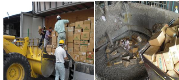
製紙工場に到着後、トラックから書類をショベルカーに移し、 ショベルカーが溶解釜まで移動して投入、攪拌される
