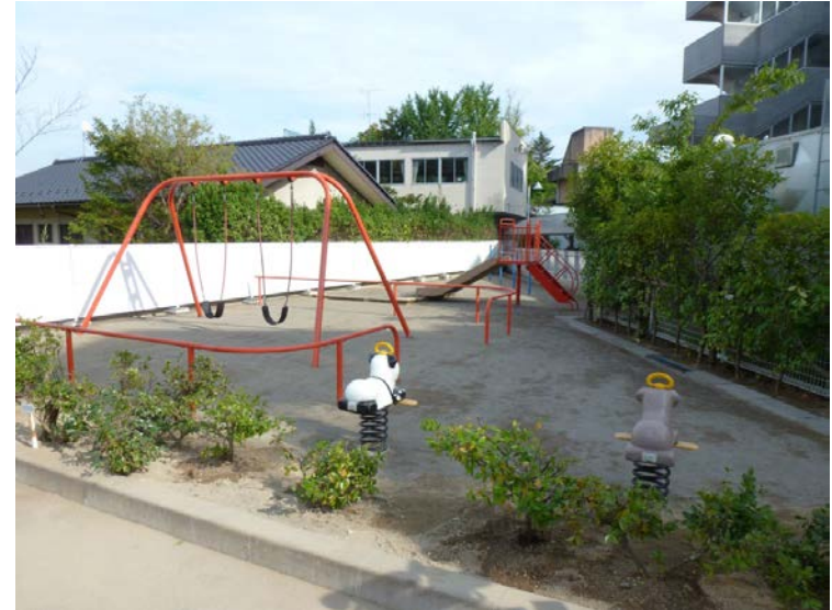
除染後 空間線量率: 0.8 \mu\text{Sv/h} 土壌表面線量率: 0.4 \mu\text{Sv/h} (コリメート: 0.2 \mu\text{Sv/h} ) (GM 218 cpm avg., BG 200 cpm)
