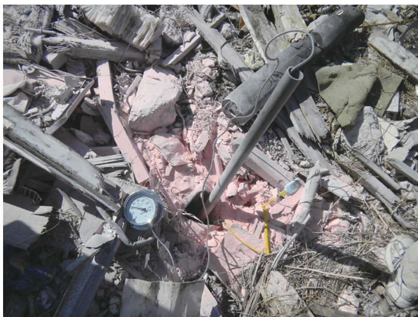
写真 3.4.5 仮置場の山（混合廃棄物）の 1 m 深温度の測定状況 （温度計は 45℃ を表示）
