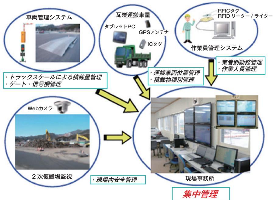
図 3.6.1 運行管理システムの概念図（大槌地区の例）
