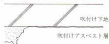
⑥ 層の損傷・欠損
