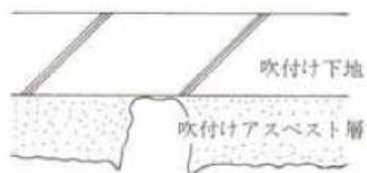
⑤ 層の局部的損傷・欠損
