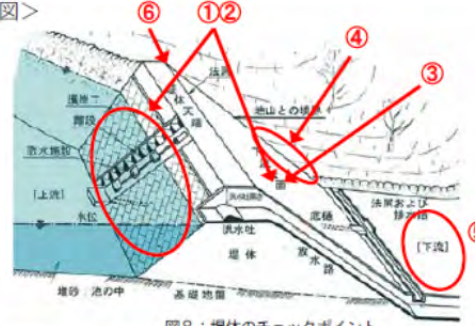
図8：堤体のチェックポイント
