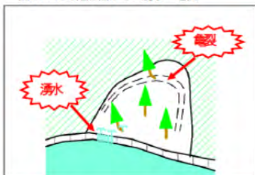
図 21：ため池法面からの湧水・亀裂
