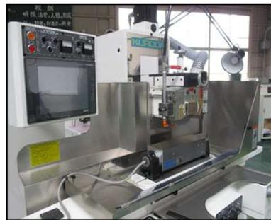
平面研削盤で加工
