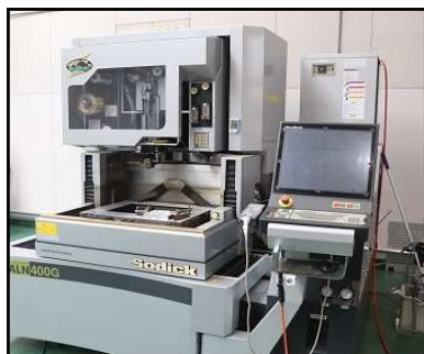
ワイヤー放電加工機で 精密穴加工
