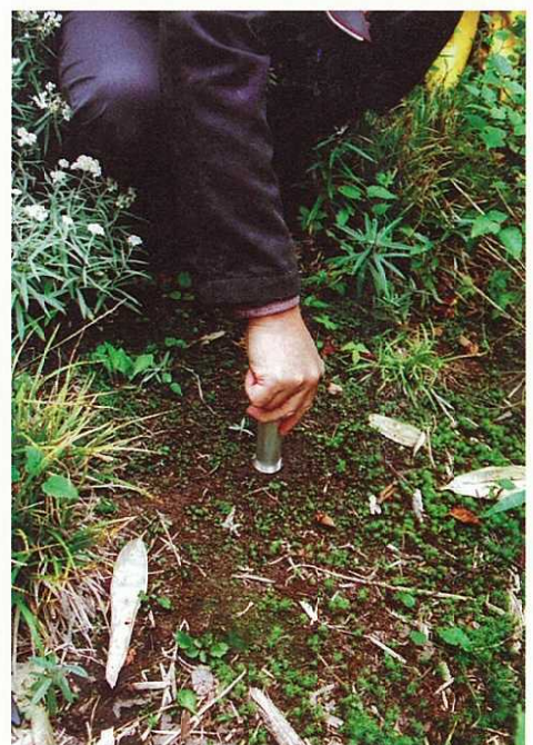
写真8-4 山中式土壤硬度計による土壤硬度の測定 (2006年9月)
