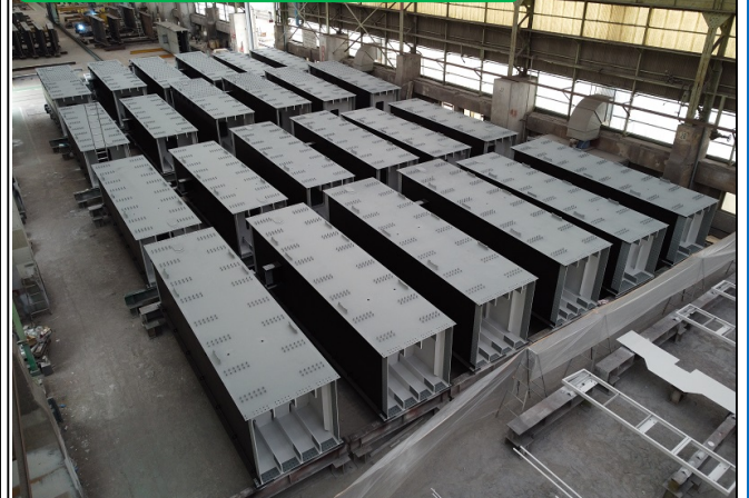
工場での製作が完了した橋桁
