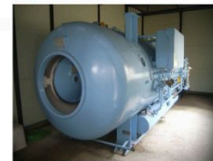
ホスピタルロック 万が一、減圧症が発症した時、再圧を行う設備
