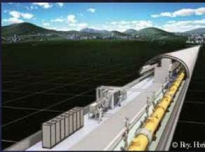
トンネル内右側に見える黄色い筒が「主線形加速器」で、この中を電子や陽電子が駆け抜けます。左側は加速器に必要な電力などを供給する装置です。中央部分はコンクリートの壁で仕切られます。
