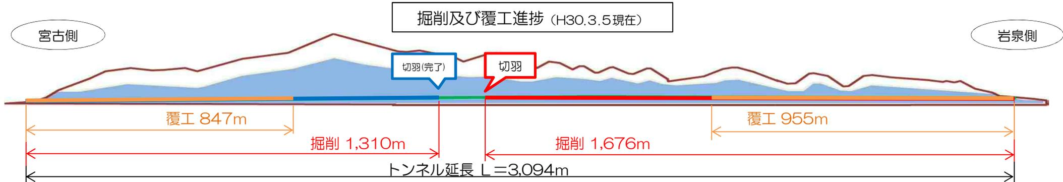
押角トンネルの掘削延長は、約2,986m（宮古側1,310m＋岩泉側1,676m）で全長の約96%の作業が完了し、残すところ約108mとなりました！
