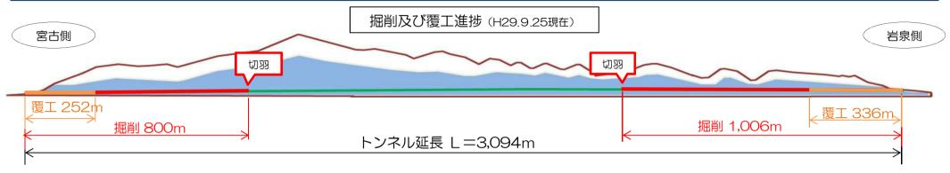
押角トンネルの掘削延長は、約1,806m(宮古側800m+岩泉側1,006m)で全長の約58%、覆エコンクリートは約588m(宮古側252m+岩泉側336m)で全長の約19%の作業が完了しています!
