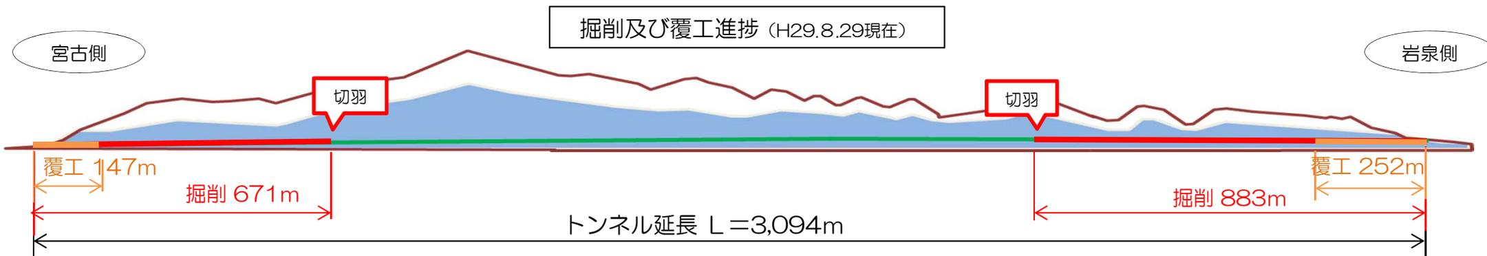
押角トンネルの掘削延長は、約1,554m（宮古側671m＋岩泉側883m）で**トンネル延長の半分を超えました！**
