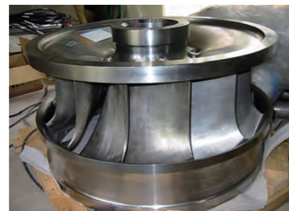
フランシス水車（柏台発電所）
