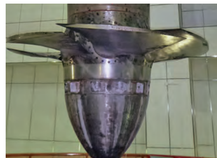
カプラン水車（四十四田発電所）
