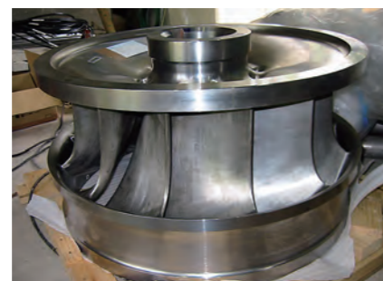
フランシス水車（柏台発電所）
