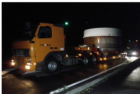
大きな部材は、交通への影響などを最小限にするために夜間に輸送しました。写真は風車の根元にあたる部材です。
