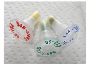
(写真2) 固相ミニカートリッジによる精製
