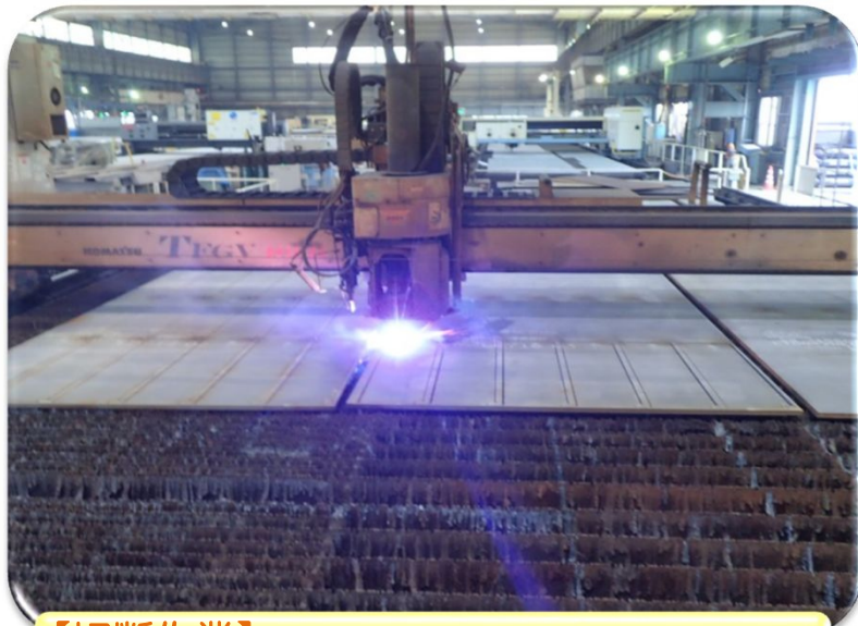
【切断作業】 鉄板をプラズマで切断します。レーザー切断も使用します。
