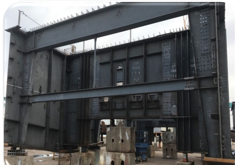
【仮組立】 工場で部材を実際に組立て、図面通り作られているか確認します。仮組立に問題が無ければ部材を分解し、塗装した後に現地に輸送します。
