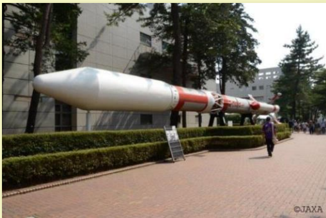
M-3SIIロケット原寸模型 (ミューズリーエスツーは、世界でも稀な惑星間軌道へ探査機を投入できる全段固体燃料ロケットです)
