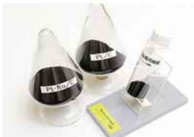
燃料電池の低コスト化を実現する低白金電極触媒
