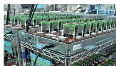
電気使用量を無線で電力会社へ送る無線機
