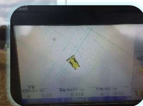
【MCブルドーザによる路体盛土の敷均し】
