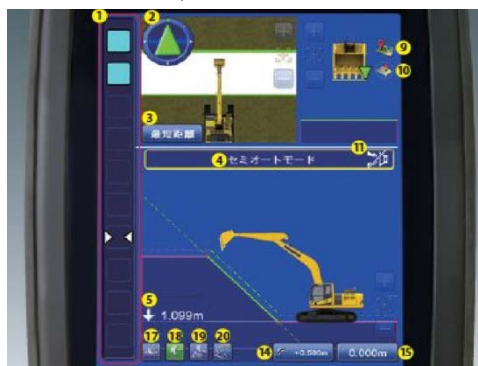
↑ 3DMCBHによる掘削 ↓ 管理画面
