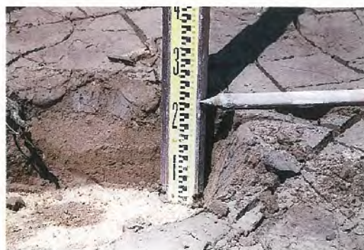
屋外運動場泥堆積 (接写) (200 mm)
