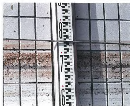
校舎外浸水位置（接写）（1,740 mm）
