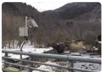
遠別川（久慈市）に設置されている危機管理型水位計
