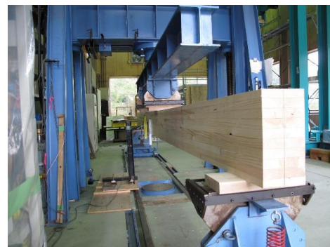
県内企業で試作したアカマツ集成材の 強度試験
