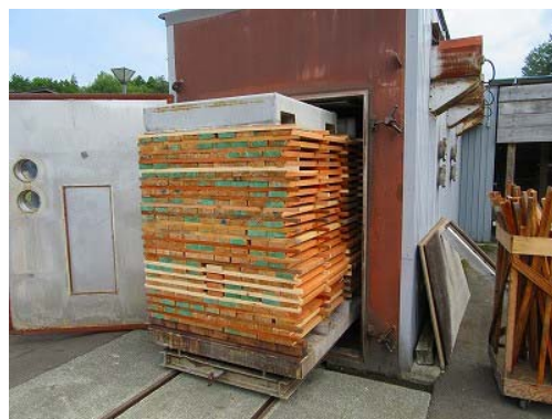
ラミナの人工乾燥試験の状況
