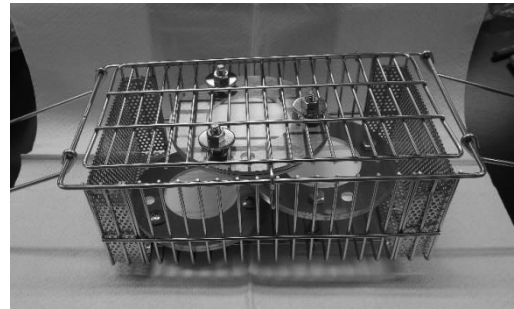
Fig. 1 POCISを取り付けたサンプリング用のかご
