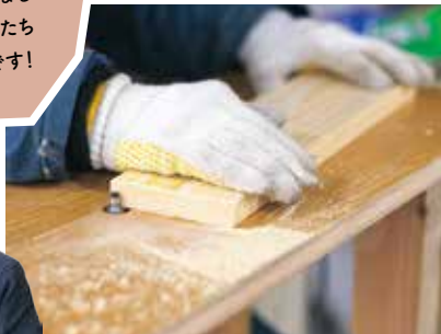
スギのとげが手を傷つけないよう、 パーツ一つひとつを丁寧に面取りします
