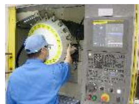
作業員による刃物の摩耗状態確認
