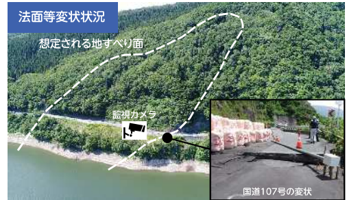
法面等変状状況 想定される地すべり面 監視カメラ 国道107号の変状
