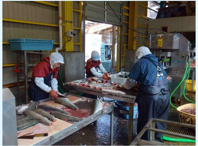
②頭、内臓を落とし、水洗いをしてから殺菌処理をします。
