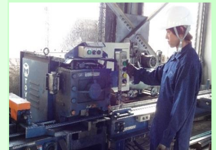
▲ 鉄筋の切断作業
