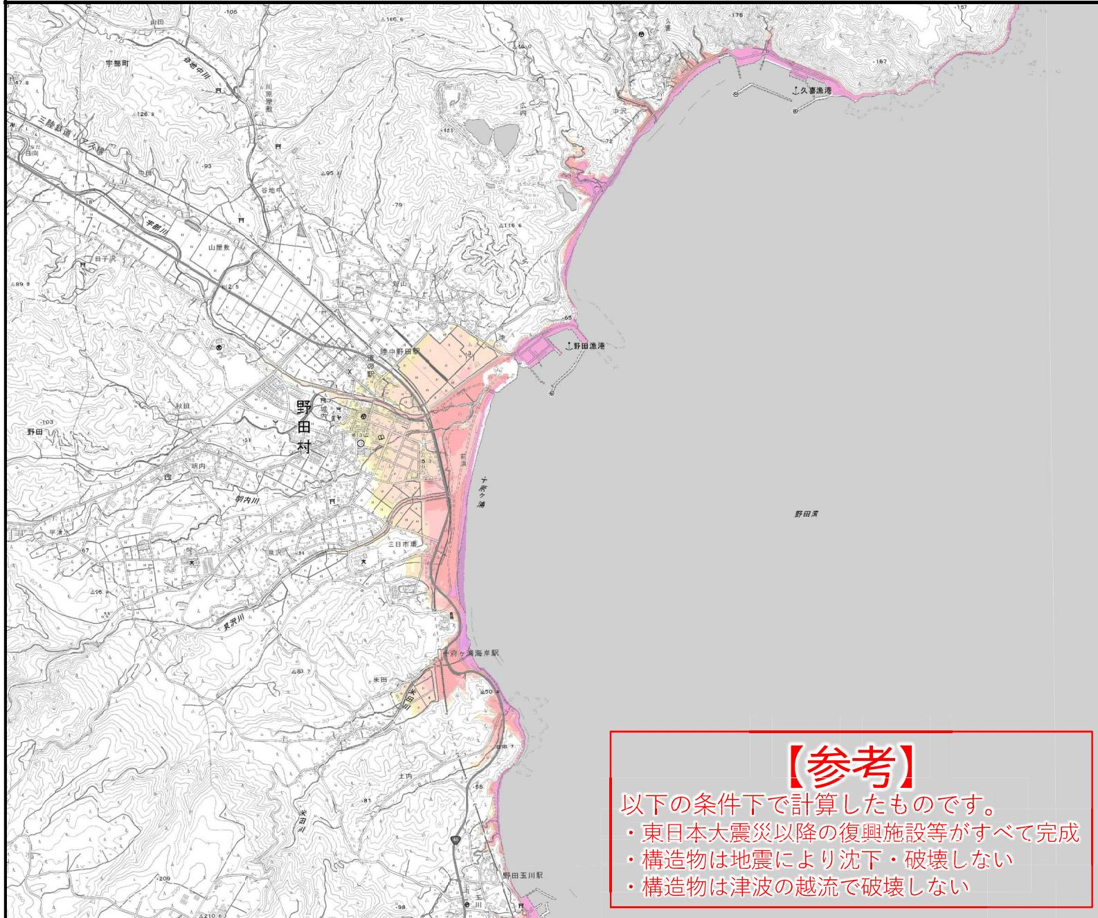
◆本資料は、防潮堤等の構造物を津波が越流しても破壊しないと仮定した場合の浸水域等を、参考のために計算したものです。
