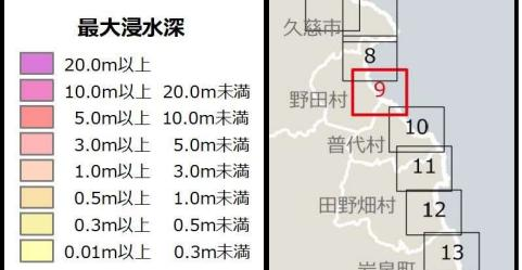
◆本資料は、防潮堤等の構造物を津波が越流しても破壊しないと仮定した場合の浸水域等を、参考のために計算したものです。
