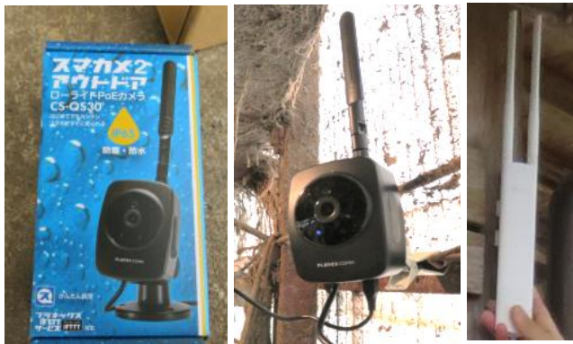
図 1-29 Wi-Fi を受信できる監視カメラ (左、中央) と Wi-Fi 中継器 (右)
