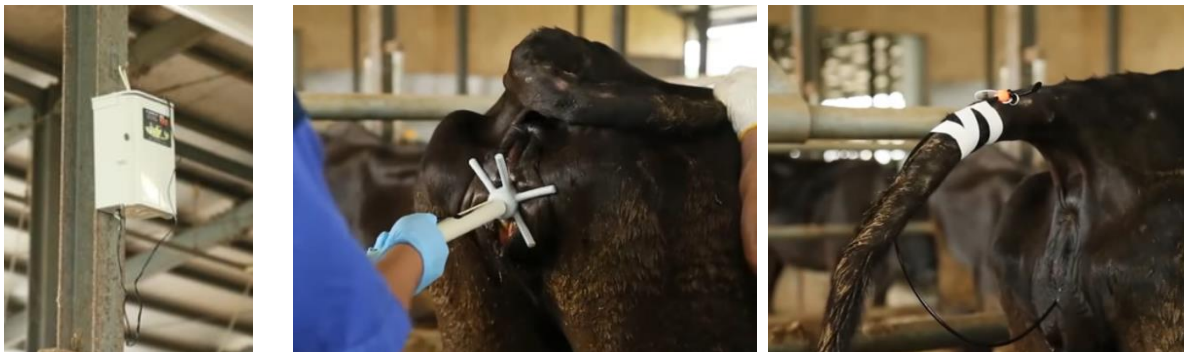
図 1-31 温度センサーから電波を受信するための子機 (左)、温度センサー挿入時 (中央)、温度センサー挿入後 (右)
