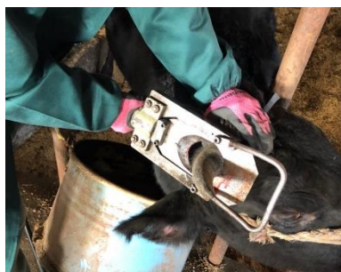
図 1-13 電動油圧式除角器 (左) 利用風景 (右)
