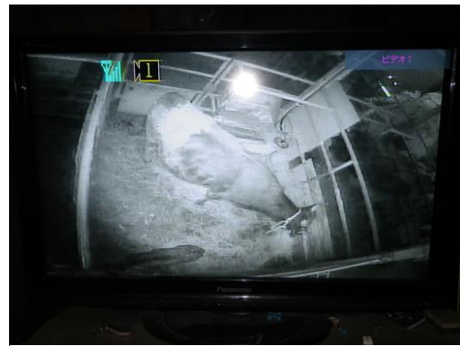
図 1-30 暗視モードによる夜間の撮影 天井に固定するタイプで撮影。 昼夜問わず牛の動きがわかります。
