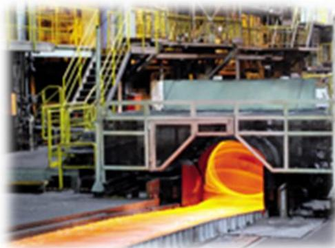
約1100度に熱せられた2tのビレット（鉄の塊）が徐々に延ばされ、最終的に11kmの棒状となり、らせん状に巻かれて出荷される様子を、熱気を感じながら見学できます。
