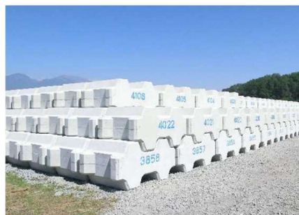
コンクリートブロックの備蓄例（浅間山）
