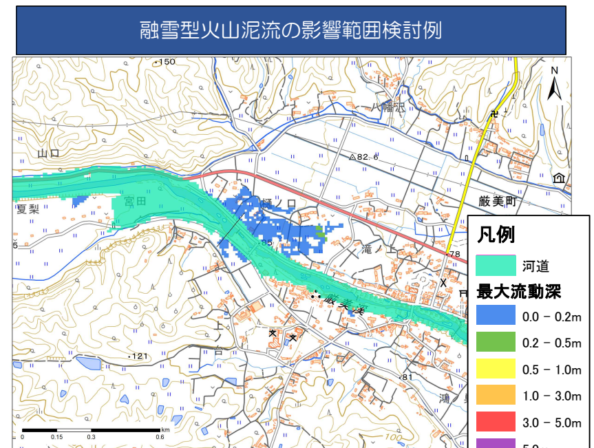
図4 磐井川(岩手県)の融雪型火山泥流計算例
