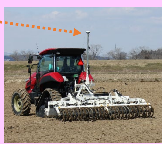
【揚水機場の基地局、GNSSレベラーによる均平作業】
