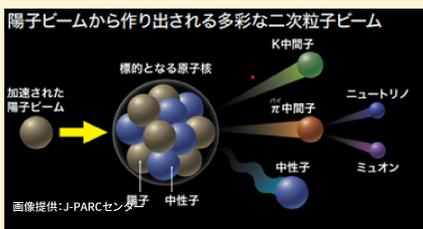
【J-PARC】 研修施設の一つである大強度陽子加速器施設J-PARC (Japan Proton Accelerator Research Complex) は、素粒子物理、原子核物理、物質科学、生命科学、原子力など幅広い分野の最先端研究を行うための陽子加速器群と実験施設群です。ほぼ光速まで加速した世界屈指の大強度の陽子ビームを標的にぶつけ、中性子、ミュオン、ニュートリノ、K中間子などの二次粒子ビームを作り出し、宇宙や物質の成り立ちにせまる実験・研究を行っています。
