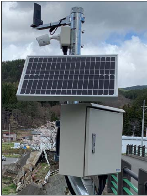
簡易型河川監視カメラ
