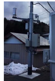
超高密度気象観測システム (POTEKA)の設置(田野畑村)
