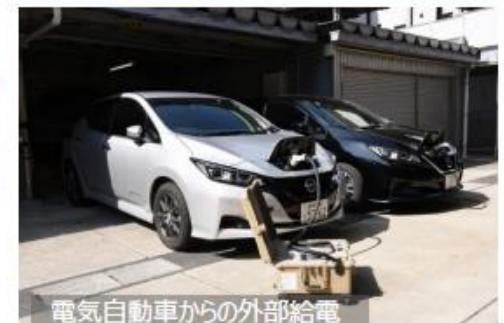
電気自動車からの外部給電
