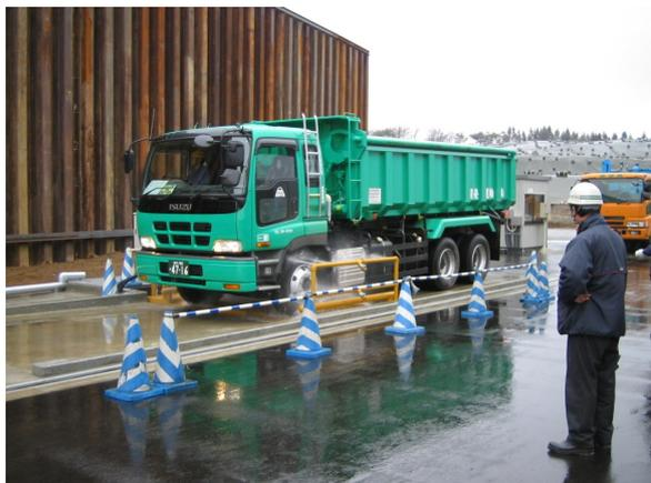
ごみを積んだトラックは、タイヤを洗ったあとに、工場へ向けて出発します。トラックのごみを積むところには、丈夫なフタが付いていて、ごみが飛び散らないように、においが出ないようにしています。
