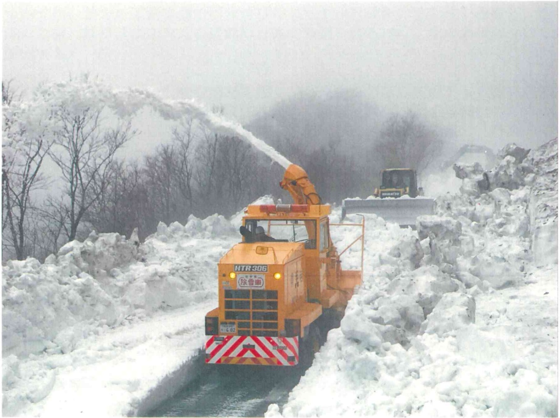
【冬期間閉鎖となる岩手県・秋田県境（岩手県側の春の除雪状況）】
